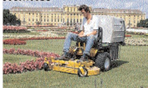
Echter Nullradius durch das original Walker Hydro-Achs-System. Das Mähwerk wird über eine Kardanwelle angetrieben. Gras und Laub werden über ein direkt getriebenes Turbogebälse direkt zum Grasfangbehälter befördert.
