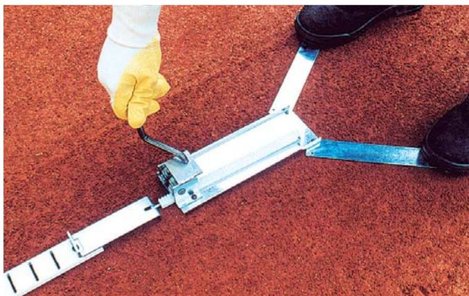
Spannvorrichtung für profilierte Linienbänder <sup>25</sup>
